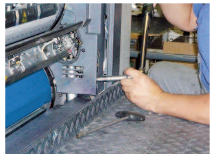
Vérifier la mise en place du blanchet et sa tension afin d'assurer la meilleure qualité d'impression
