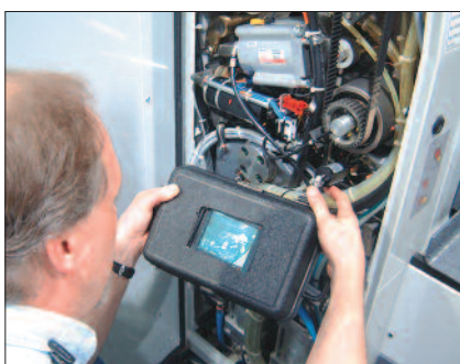
Algunos impresores y sus suministradores están utilizando una cámara digital web con un transmisor sin cable y un enlace Internet de banda ancha para identificar más rápidamente y resolver los problemas en la máquina desde centros de servicio técnico a distancia. Este ejemplo es el ServiceVision de manroland.
