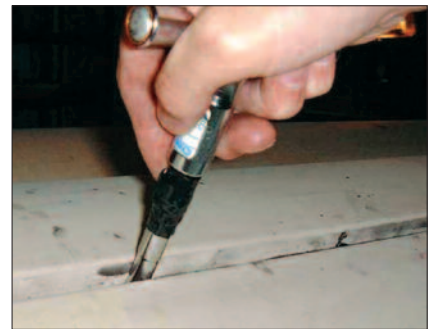
Tensado de la mantilla con una pequeña llave dinamométrica. Foto : Trelleborg Printing Solutions.
