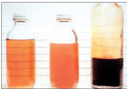
Una simple inspección visual del aceite puede revelar rápidamente muchas de las características de su estado (aceite nuevo, utilizado o defectuoso). Foto : Swansea Tribology Services.
