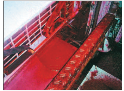
Las protecciones sucias con huecos incorrectos facilitan el goteo de la tinta provocando manchas y roturas en la banda. Foto : manroland.
