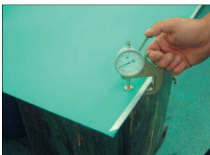
Una galga de muelle mide el espesor de la mantilla cuando está fuera de la máquina. Foto : Trelleborg Printing Solutions.
