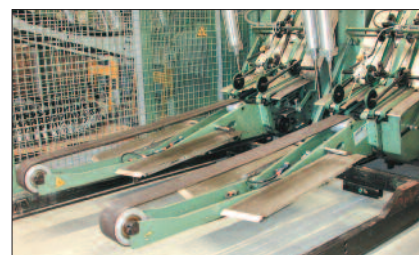
Limpiar las guías de la cinta portadora del brazo oscilante para evitar daños en las cintas de tensión de la unidad de enrollado. Foto : Muller Martini.
