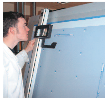
La inspección de la plancha es un control de calidad clave para reducir los tiempos no efectivos en la máquina. Foto : KPG.
