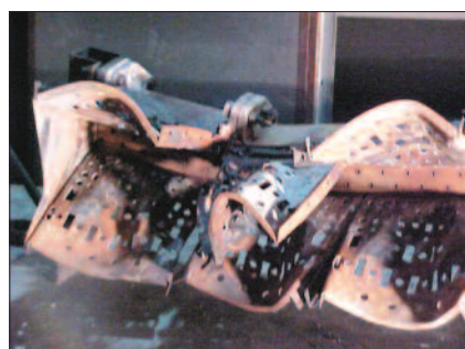
El resultado de un pobre mantenimiento del quemador y/o ajuste incorrecto de la mezcla aire-gas, puede destruir el quemador.
