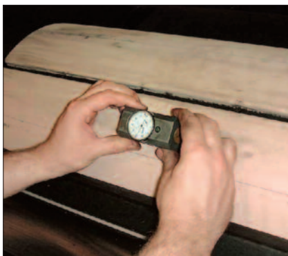
Utilizar un comprobador de altura de la mantilla con respecto a los aros del cilindro de la máquina. Foto : manroland.
