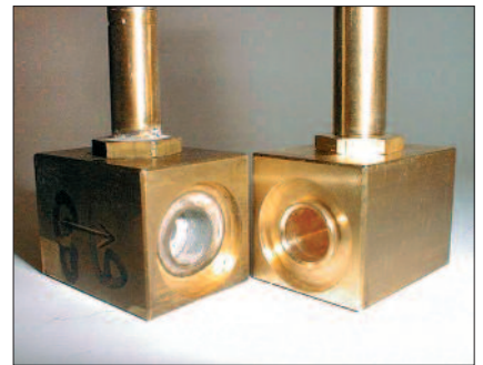
Corrosión de partes mecánicas al utilizar un aditivo incorrecto o agresivo o alcohol de baja calidad. Foto : Technotrans.
