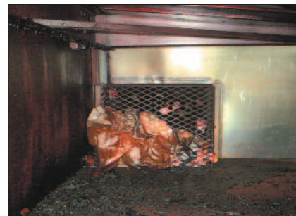
Si las partículas de papel que se adhieren a las mallas del filtro no se eliminan, se queman y se desintegran formando finas partículas que provocan fallos en el interruptor de presión, deteniendo la producción o causando condensación. Foto : MEGTEC.
