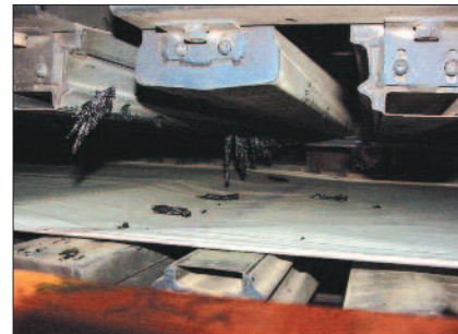
Los residuos de papel y tinta pueden formar sedimentos duros y punzantes que sobresalen de las ranuras de la barra de aire generando manchas y roturas de la banda. Foto : MEGTEC.
