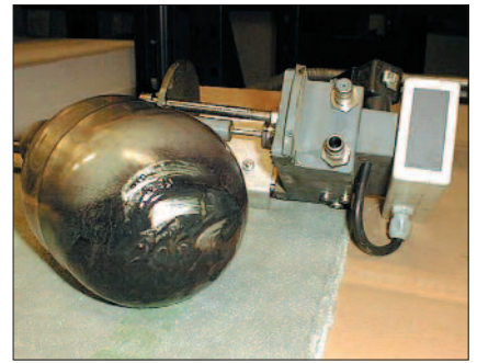
La acumulación de partículas en el flotador que estabiliza la adición de alcohol puede generar una variación en el contenido de alcohol y en la solución de mojado. Foto : Technotrans.
