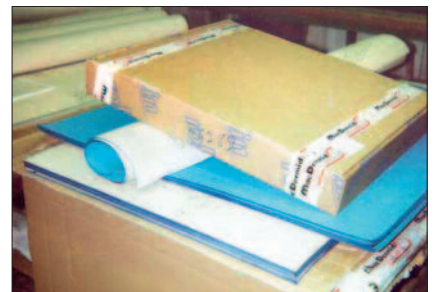
Las mantillas mal almacenadas se dañarán y a menudo quedarán inutilizadas. Ver Página 13 para un almacenamiento correcto. Foto : Trelleborg Printing Solutions.
